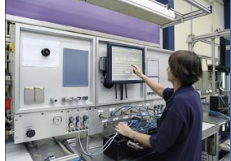
Venttiilien testauksessa Danfossin tehtaalla Tanskassa hyödynnetään YIT:n toimittamaa välineistöä ja tiedonkeruujärjestelmiä.
